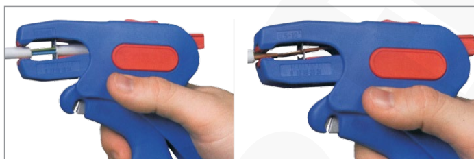
Zdejmowanie izolacji zewnętrznej
