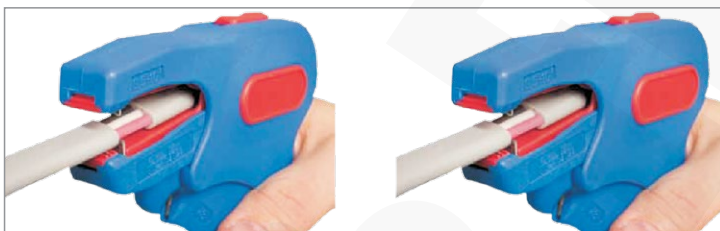
Zdejmowanie izolacji zewnętrznej
