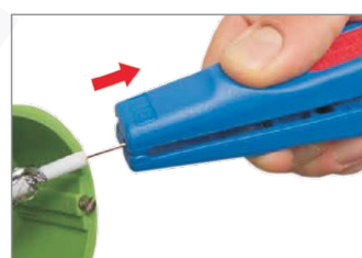
Zdejmowanie izolacji wewnętrznej.
