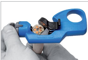
Dobranie głębokości nacinania izolacji
