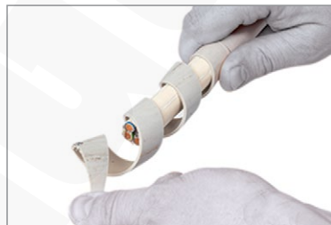
Efekt spiralnego nacinania izolacji
