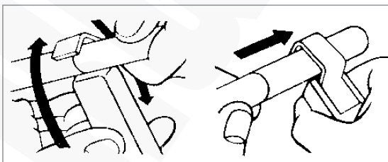
Zdejmowanie izolacji z „końca” kabla
