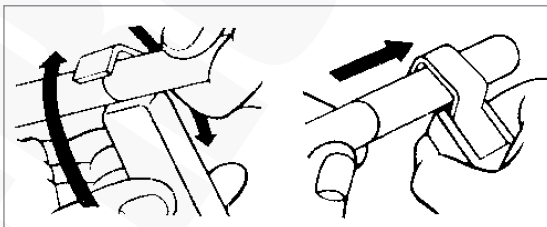
Zdejmowanie izolacji z „końca” kabla
