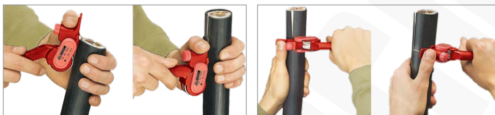
Nacinanie "wzdłużne" izolacji
