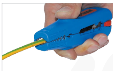
Obwodowe zdejmowanie izolacji zewnętrznej z przewodów.
