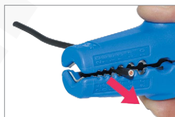
Zdejmowanie izolacji wewnętrznej z przewodów.
