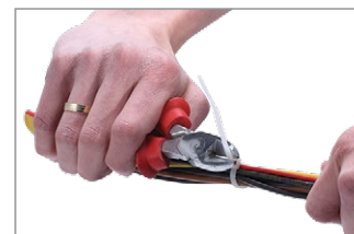
1.4 - Odciąć wystającą część opaski za pomocą szczypiec, zostawiając kilka mm jako zabezpieczenie
