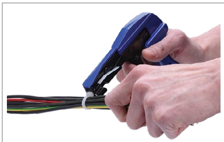
2.3 - Zaciśnąć opaskę za pomocą narzędzia
